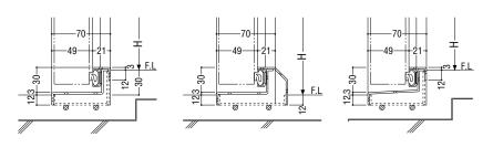
ステンレス材質 : SUS304 // 板厚 : t=1.5mm
